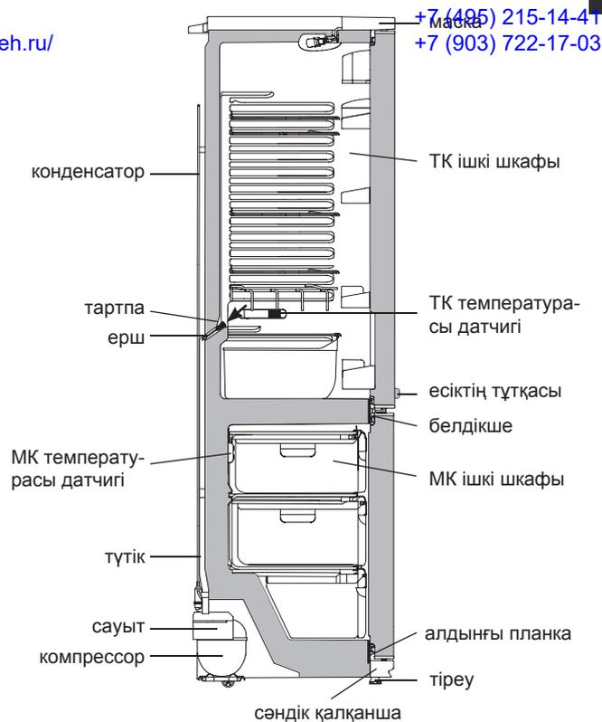
7 сурет – ТК еріген су ағызу схемасы
