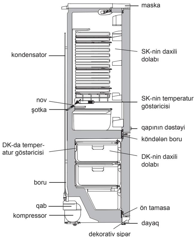
Şəkil 7 — SK-dən qar suyunun axma sistemi
