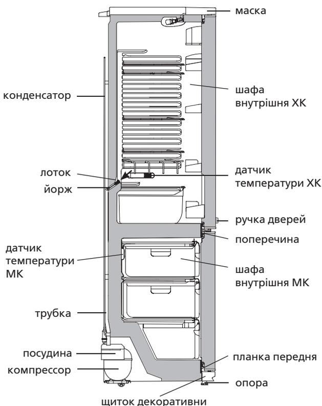
Рисунок 7 — Схема зливу талої води із ХК
