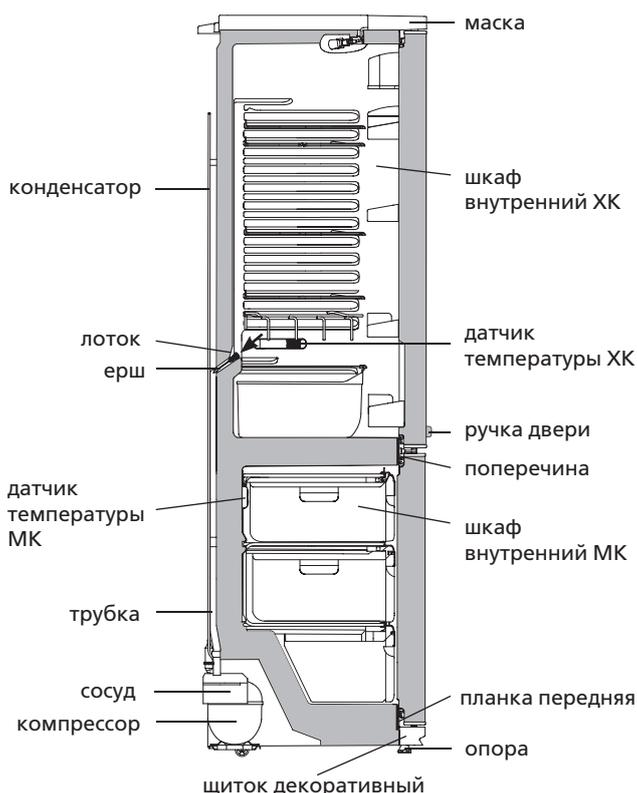
Рисунок 7 — Схема слива талой воды из ХК
